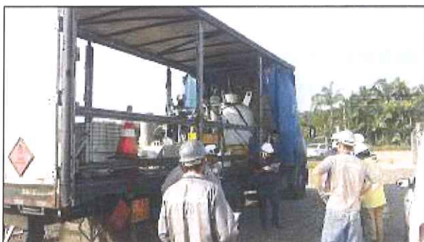
Figura 2: Tanque de fornecimento para recarga do odorante.
