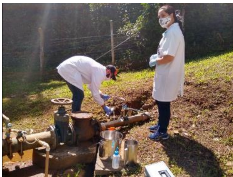
Figura 1: Coleta de água bruta proveniente do Córrego São Marcos, na entrada da ETA Compacta de Rio Fortuna (05/11/2021).
