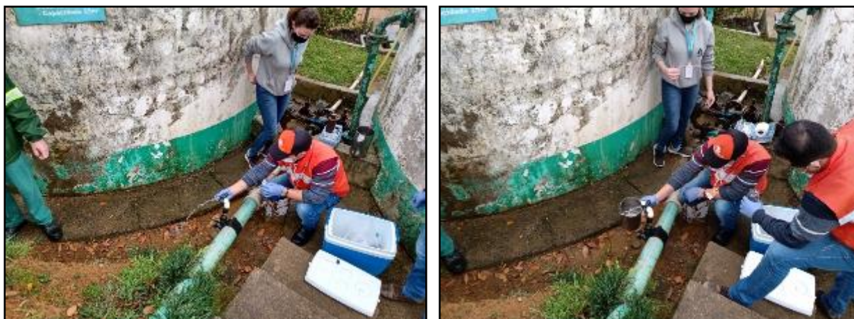
Figura 2: Coletas de amostras de água tratada na saída da ETA do município de Leoberto Leal (30/08/2021).
