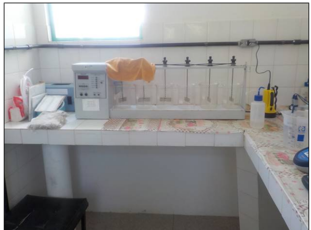
Figura 20: Área interna do local onde está localizado o laboratório da ETA de Alfredo Wagner onde são realizados testes de rotina para a dosagem dos produtos químicos utilizados no tratamento.
