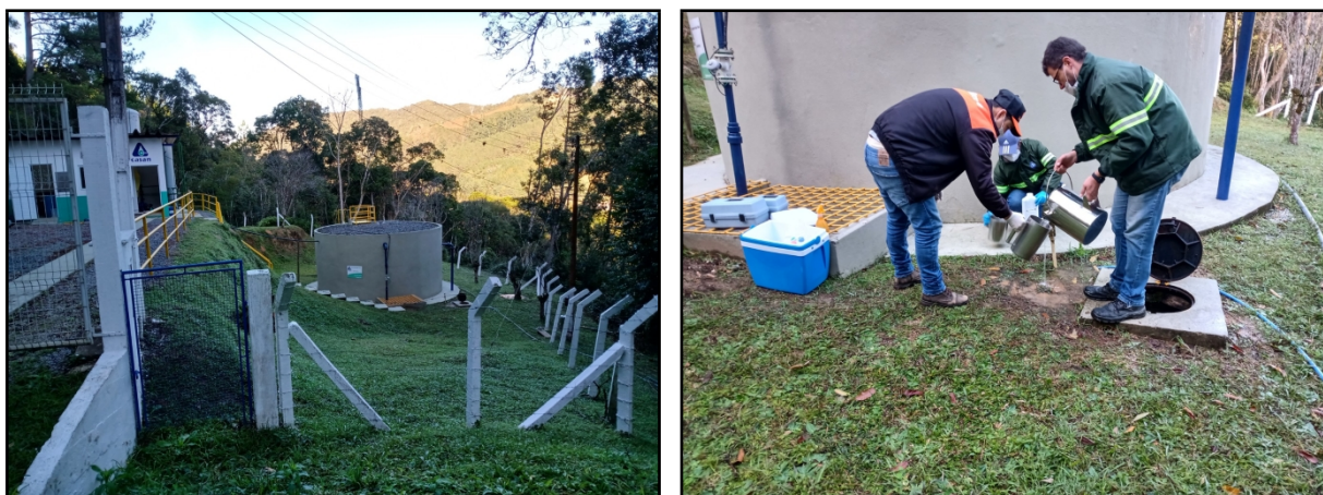
Figura 3 - Coleta de amostras de água tratada no reservatório localizado na ETA de Angelina (01/07/2021).
