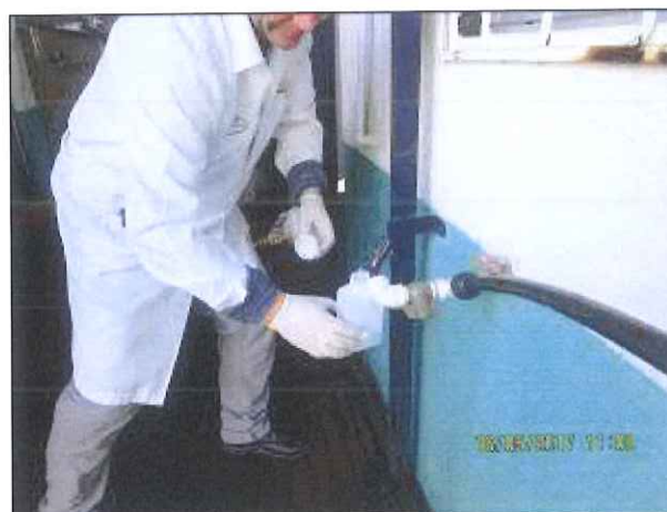
Figura 3: Coleta de amostra de água tratada da ETA Catanduvras.
