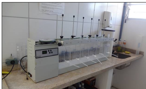
Figura 16: Recomendação 13, realização de teste de jarros (Jartest) para assegurar boas práticas de operação da ETA.
