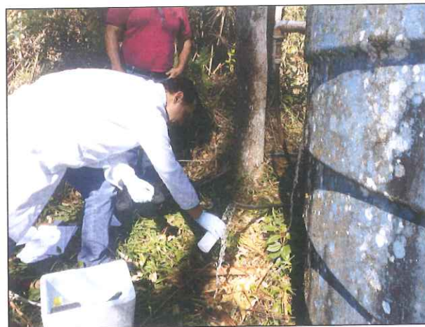
Figura 4: Coleta de água bruta no Sistema Alternativo Coletivo de Abastecimento de Água para Consumo Humano da comunidade de Pinheiral, município de Major Gercino
