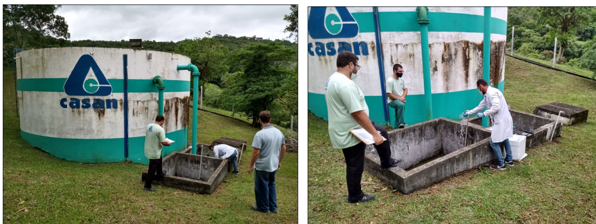
Figura 3: Reservatório do município de Treze de Maio e coleta de amostras de água tratada (21/12/2020).
