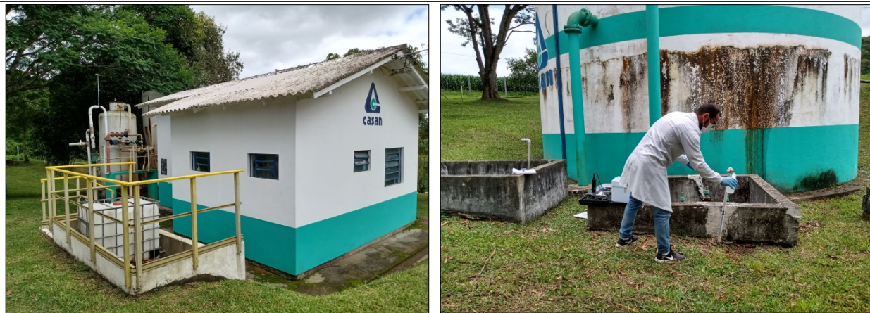
Figura 2: Visão geral e coleta de amostra de água tratada na ETA de Treze de Maio imediatamente antes da entrada no reservatório anexo à ETA (21/12/2020).
