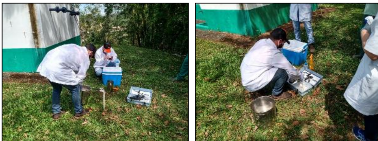
Figura 1: Coleta de amostra de água bruta e análises de campo na entrada da ETA do município de São Martinho (04/11/2021).
