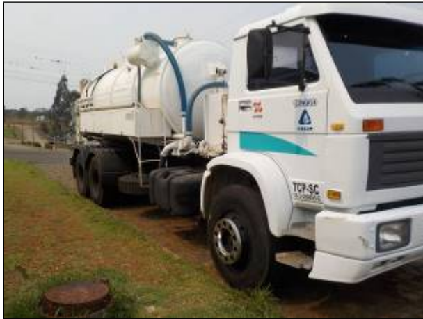
Figura 11: Caminhão Hidro jato pertencente à Concessionária.
