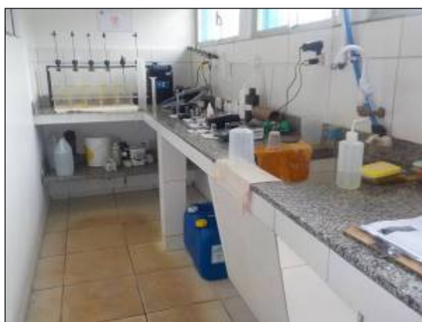
Figura 46: Área interna do local onde está localizado o laboratório da ETA Catanduvás onde são realizados testes de rotina para a dosagem dos produtos químicos utilizados no tratamento.
