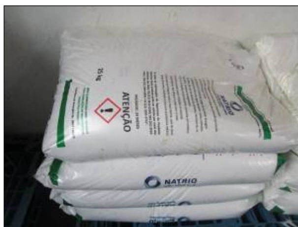
Figura 52: Detalhe do armazenamento do Carbonato de Sódio (barrilha), produto utilizado para a correção do pH da água no tratamento realizado na ETA Catanduvas.
