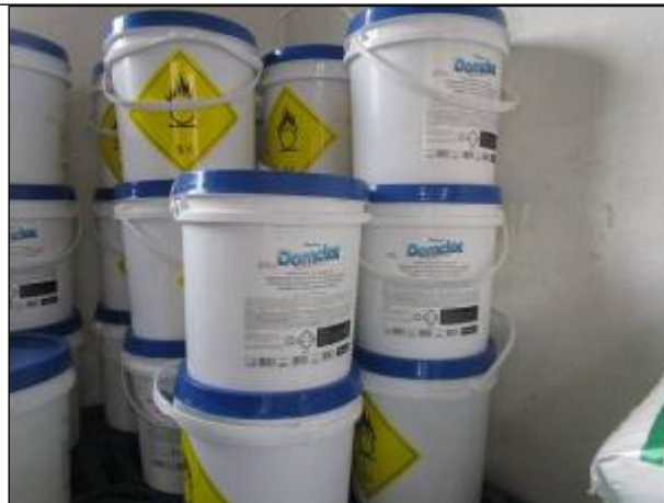
Figura 50: Detalhe dos recipientes que armazenam o Hipoclorito de Cálcio (cloro granulado) na ETA Catanduvas, produto utilizado para desinfecção na ETE.
