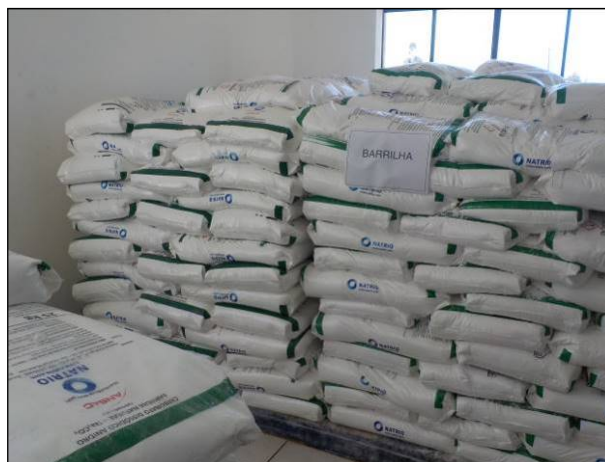
Figura 24: Acondicionamento dos produtos químicos (barrilhas) em boas condições, sobre paletes.
