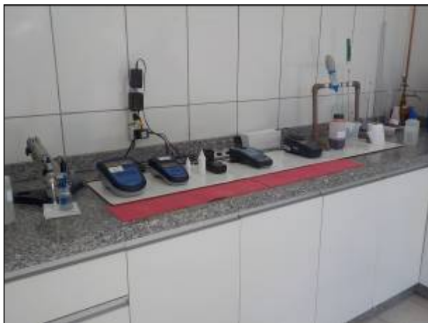
Figura 19: Local onde está localizado o laboratório da ETA onde são realizados testes de rotina para a dosagem dos produtos químicos utilizados no tratamento.
