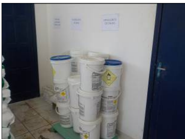
Figura 25: Acondicionamentos adequados de Cloro- Flúor, Fluossilicato de Sódio e Hipoclorito de Cálcio.
