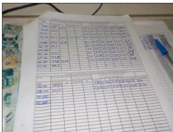
Figura 46: Planilha de dados para controle por parte dos operadores dos parâmetros, tanto da água bruta como da tratada.
