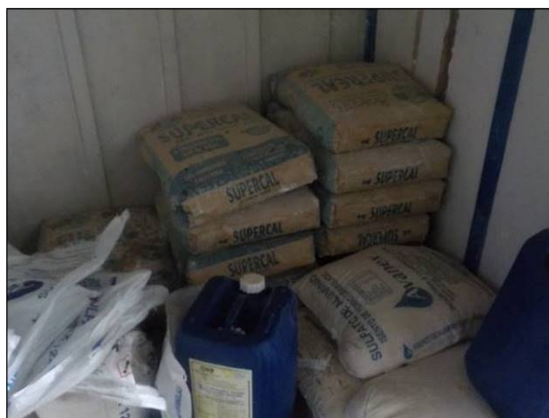
Figura 42: Detalhe dos produtos químicos armazenados em local improvisado e sem separação ou organização.
