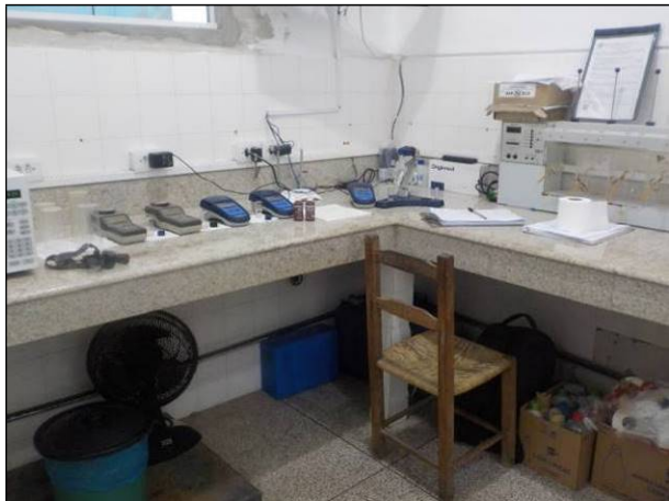
Figura 39: Laboratório para análises dos parâmetros da água bruta e tratada no SAA Papanduva. Mobiliário em condições insatisfatórias, principalmente falta de armários para armazenagem dos equipamentos e cadeiras inadequadas para o trabalho.
