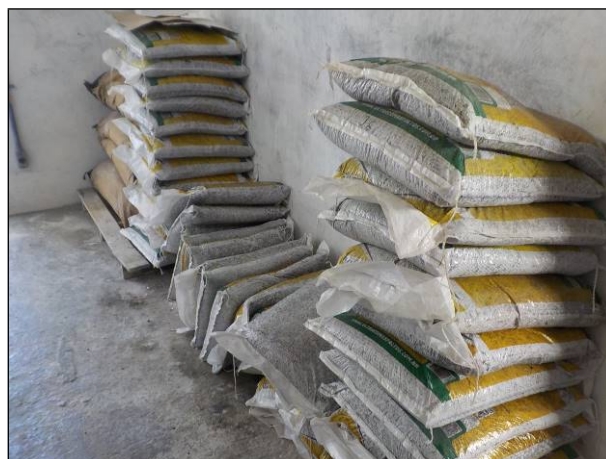
Figura 40: Local de armazenagem dos produtos químicos, arejado, porém em contato com o chão e as paredes úmidas.
