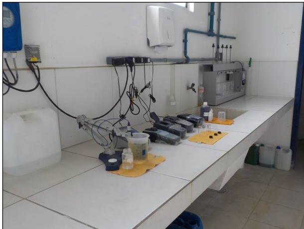
Figura 41: Bancada para testes da qualidade da água e verificação do tratamento na ETA Passo de Torres, local adequado, necessitando lugar específico para armazenar os produtos químicos e vidrarias usadas no laboratório.
