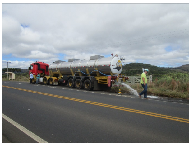
Figura 16: Caminhão-pipa fazendo o descarte da água bruta em local que escorrerá para a área de captação no rio Antonina.
