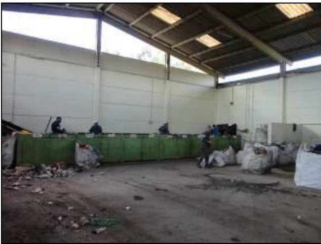
Segregação de materiais é feita por meio de esteiras e armazenamento em fardos por empresa terceirizada.
