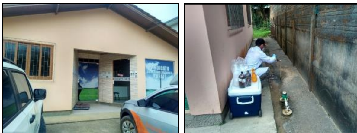
Figura 4: Coleta de amostra de água tratada no cavalete imediatamente subsequente à Casa de Química no centro de Rancho Queimado.
