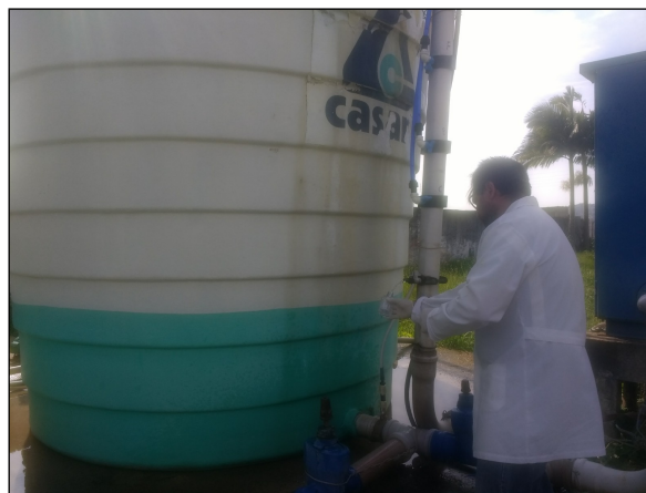
Figura 4: Coleta de amostra de água bruta dos mananciais subterrâneos na Unidade de Tratamento Areias.
