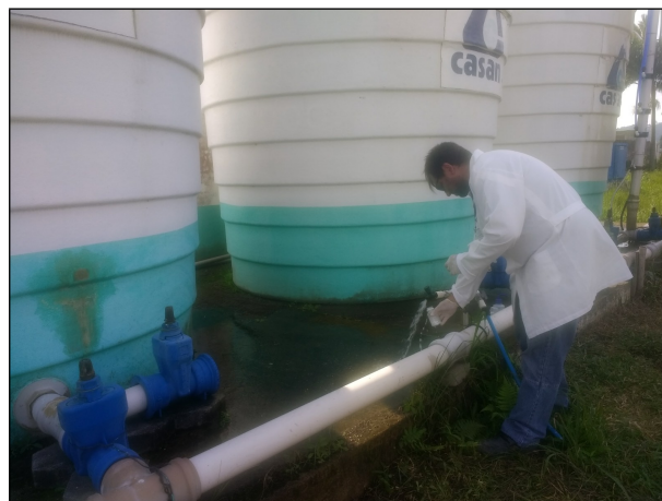
Figura 10: Coleta de amostra de água tratada na Unidade de Tratamento Areias.
