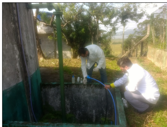
Figura 14: Coleta de amostra de água tratada no Reservatório Sorocaba.
