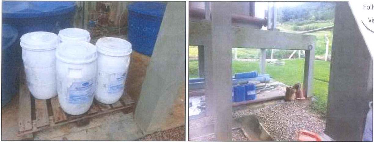
Figura 17: Produtos químicos dispostos inadequadamente
